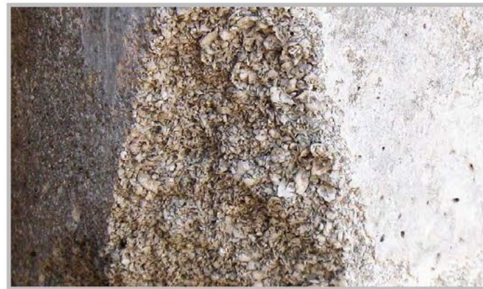
תמונה 1. אבן חוף (Beachrock). ניתן לראות את המבנה הפנימי של האבן: צדפים וחול עברו צמנטציה
